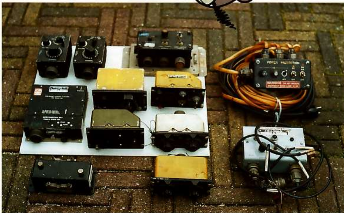
Een collectie afstandsbedieningen (junctionboxes) voor vliegtuigradio-communicatie
